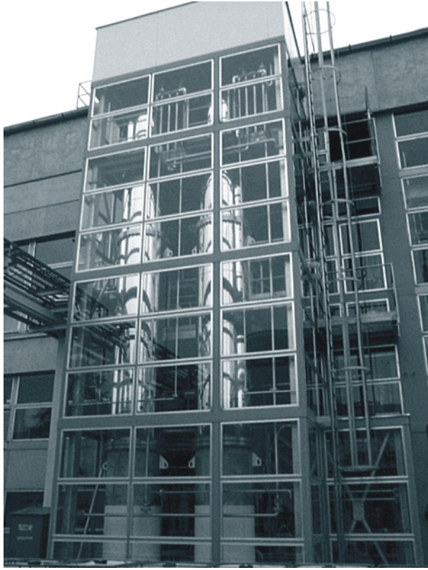
I. Szilikagél töltetű \varnothing 1\text{m} \times H=10,5\text{m} adszorpciós kromatografáló kolonna
